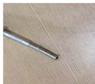
17、剥除铝管后的电缆
