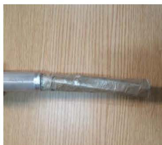
18、剥除铝管后的电缆
