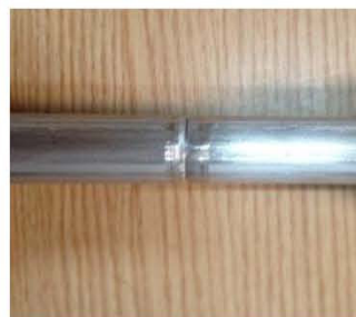
14、使用切管钳将铝管割出痕迹，即可
